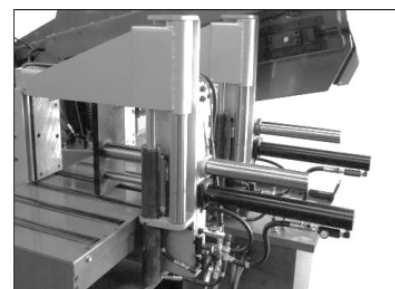
Пластина для регулировки высоты подъема пыльной рамы.
