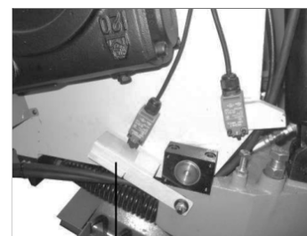
Пластина для регулировки высоты подъема пыльной рамы.
